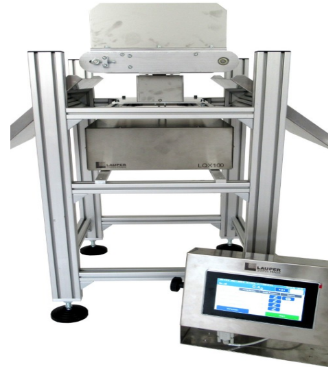
Abbildung 1: LQX100 Kontrolleinheit in Gestellrahmen mit integrierter Steuerung und abgestzter Anzeige/Bedieneinheit
