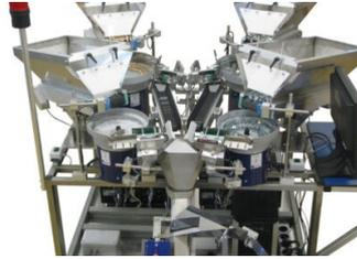
Abbildung 3: 4-Topf-Wendelförderanlage mit Bunker und spezieller Zuführung in den Trichter
