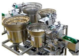
Abbildung 2: 4-Topf-Wendelförderanlage mit (Sammel-) Zuführband in LVX Verpackungsmaschine
