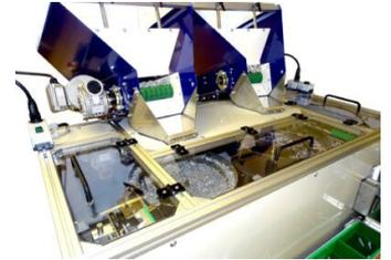
Abbildung 4: 2-Topf-Wendelförderanlage mit Bunker und Schallschutz (von oben zugänglich)
