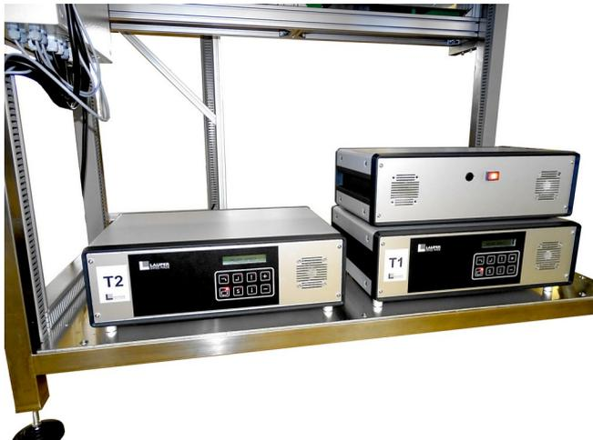
Abbildung 5: Jeder Wendelförderer wird mit einer eigenen Steuerung angesteuert und dem Bauteil entsprechend eingestellt.
