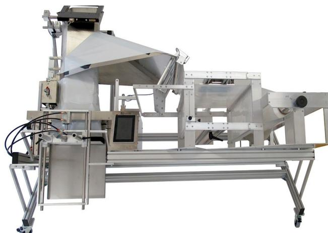
Abbildung 2: LVX660 mit Rollenantrieb und Druckerrahmen, schräg 45°, mit Schräggestell
