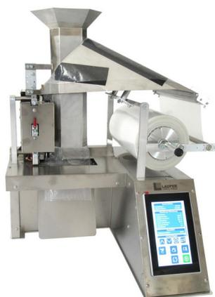
Abbildung 1: LVX300 ohne Rollenantrieb, gerade 90°, ohne Schräggestell
