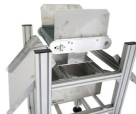
Abbildung 4: LQX100 Kontrolleinheit auf Gestellrahmen, Anwendung nach Abtransportband
