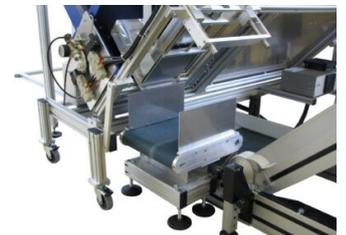
Abbildung 5: LQX100 Kontrollwaage nach der Verpackungsmaschine
