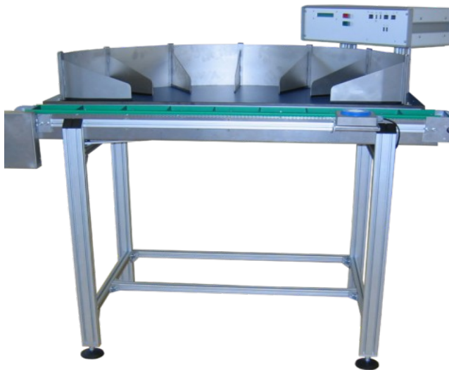
Abbildung 1: Sortiertisch mit Bandzuführung, normalerweise als Zuführung in eine Lauper LVX Verpackungsmaschine
