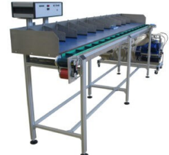
Abbildung 6: LB100 Speziallösung, Extra langer Sortiertisch, kundenspezifisch konfigurierbar.
