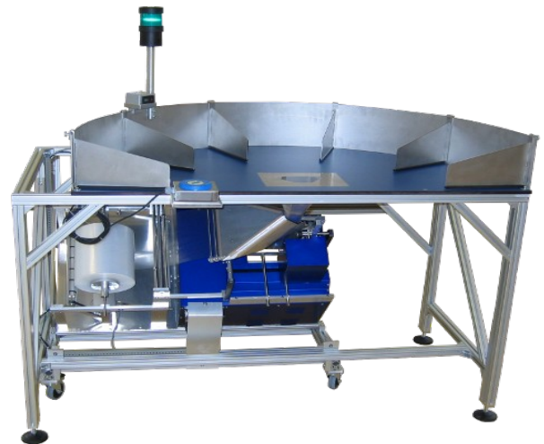
Abbildung 2: LB100 Sortiertisch mit Einwurföffnung in eine Lauper LVX Verpackungsmaschine (Anordnung unter dem Tisch)
